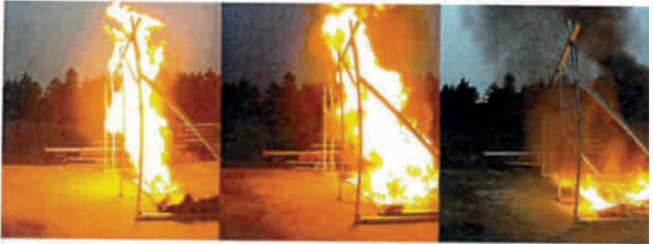
Bild 10 Aufnahmen des Brandverhaltens der Biogastolie.
